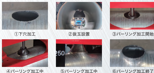
バーリング(引抜)加工工程
